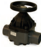
VANNE PVC A MEMBRANE Avec brides fixes suivant EN/ISO/DIN. DIN 8063 PN 10/16. Encombrement suivant DIN 3202 PN 10. Joints EPDM, FPM ou EPDM/PTFE REF. DKOV
