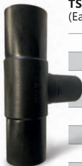
TR - TÉ ÉLECTROSOUDABLE AVEC DÉRIVATION LISSE PE 100 SDR 11 (Eau 16 bar, Gaz 10 bar)
