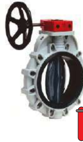
VANNE PAPILLON PVC CORPS EN PP GR PN 10. Manchette EPDM ou FPM Commande manuelle par réducteur REF. FKOV/CR
