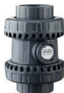
CLAPET DE RETENUE A BOULE PVC EASYFIT avec ressort en inox 316 revêtu PTFE PN 16. Femelles à coller Joints EPDM ou FPM REF. SSEIV
