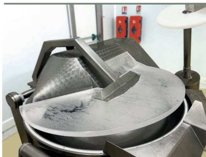
Couvercle de broyeur en PMMA COULÉ
