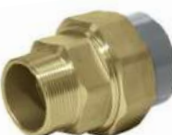
MANCHON UNION ABS - PN 10 Femelle à coller / Laiton Mâle fileté gaz conique - Joint plat NBR REF. 11217
