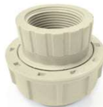
UNION 3 PIÈCES PP EMBOÎTURE à souder Femelle à souder. emboîture/taraudée pas du gaz cylindrique. Joints toriques EPDM et FPM REF. BIFGM
