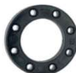
BRIDE TOURNANTE AME ACIER Revêtu PP. Perçage PN 10 suivant. DIN 2501. Série spéciale emboîture. REF. ODSA
