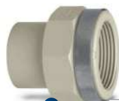
MANCHON D'ADAPTATION PP - BOUT A BOUT Avec bague de renfort SDR 11 (PN 10) Taraudé pas du gaz REF. MFBM
